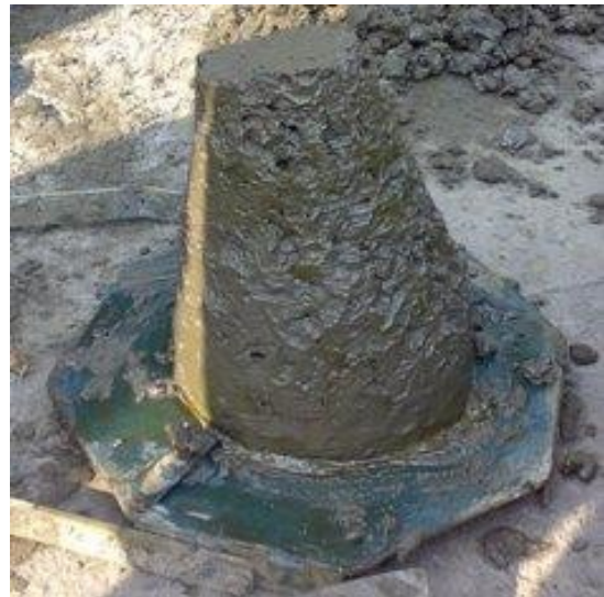
Fig.no. 5.3 Slump Cone Test
