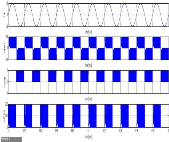
Figure 22: Grid current & switch voltages  $V_{DS1}$ ,  $V_{DS6}$  and  $V_{DS4}$
