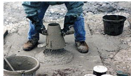
Fig.No3.1 Slump Flow Test
