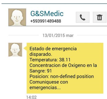
Fig. 6. SMS enviado por el dispositivo ante una emergencia.
